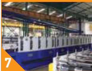
7 PERFILAÇÃO INFERIOR E PRÉ AQUECIMENTO
